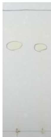
図1. 培養液中に検出されたレインアンスロン (A) LKM10070 (B) LKM512 黄色に呈色されたスポットがレインアンスロン (Rf値=0.64)
